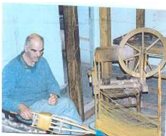
تصویر ۱۹ کوپی پیچی، باز کردن ابریشم توسط چرخ ماسوره پیچی
